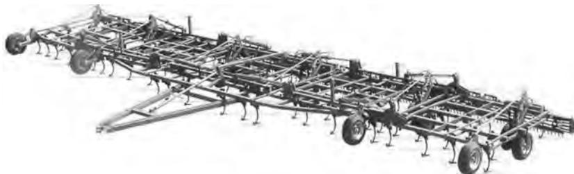
Рисунок 58 – Культиватор паровой КП-15
