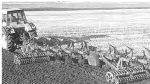
Рисунок 12 – Секционный плуг
