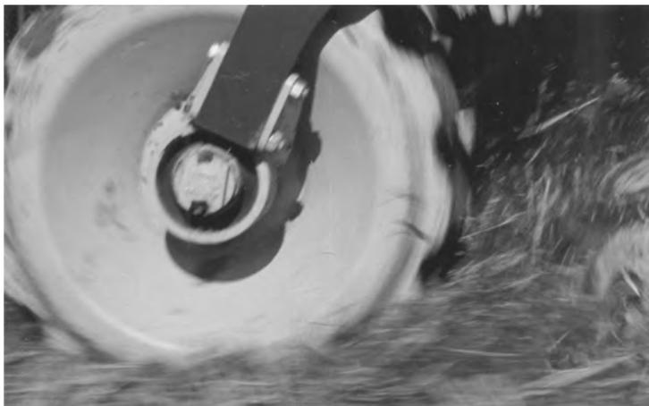
*Рисунок 78 – Кольчато-зубчатый каток в работе*
