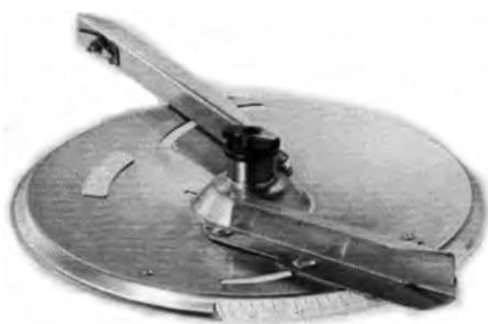
*Рисунок 126* – Регулировка ширины захвата поворотом разбрасывающих лопастей
