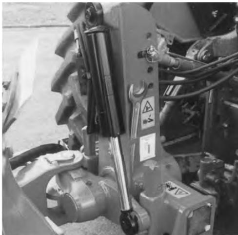
*Рисунок 9 – Гидроцилиндры механизма поворота*
