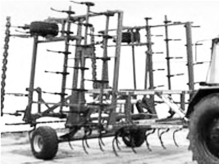
Рисунок 57 – Культиватор паровой КП-9,0
