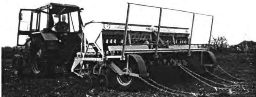
*Рисунок 98 – Сеялка зерновая прессовая СЗП-3,6А*
